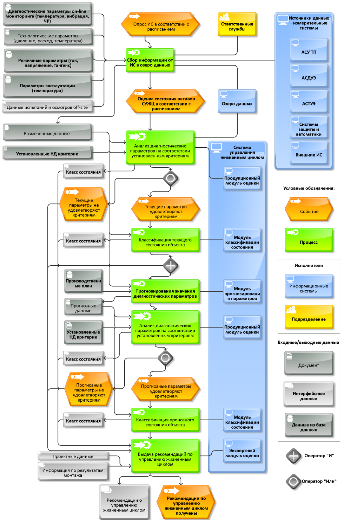
Рисунок 3.3 – Процесс автоматизированного контроля и диагностики технического состояния для управления жизненным циклом
